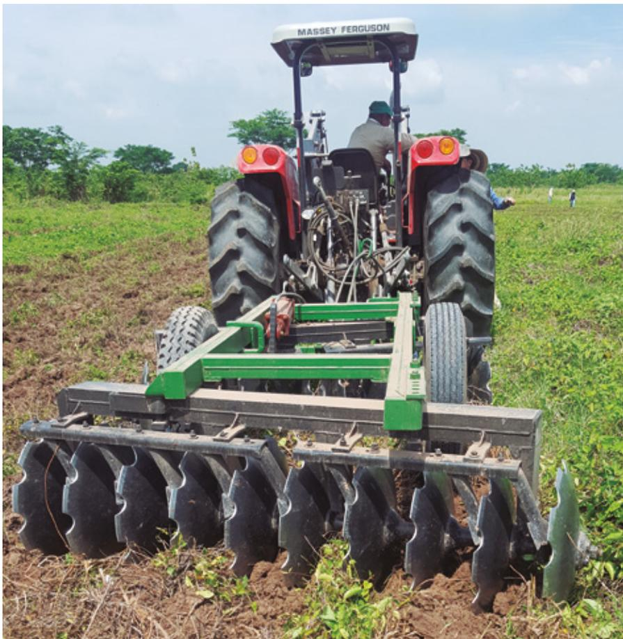
**Figura 2.** Labor de pase de rastra para preparación de terreno.
