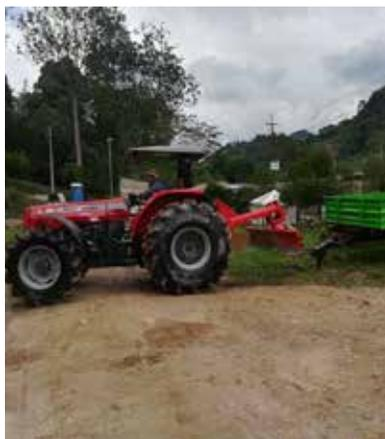
Tractor agrícola - cuchilla trasera zanjadora y remolque multiusos (5 toneladas) - La Suiza
