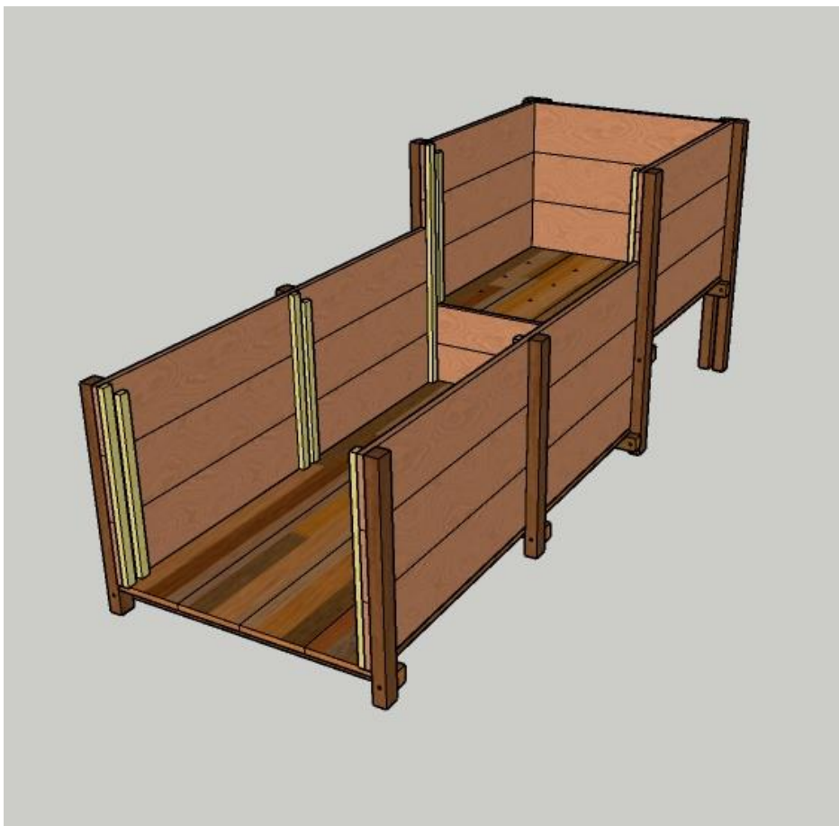
Vista general del ensamblaje de pisos y tableros laterales
